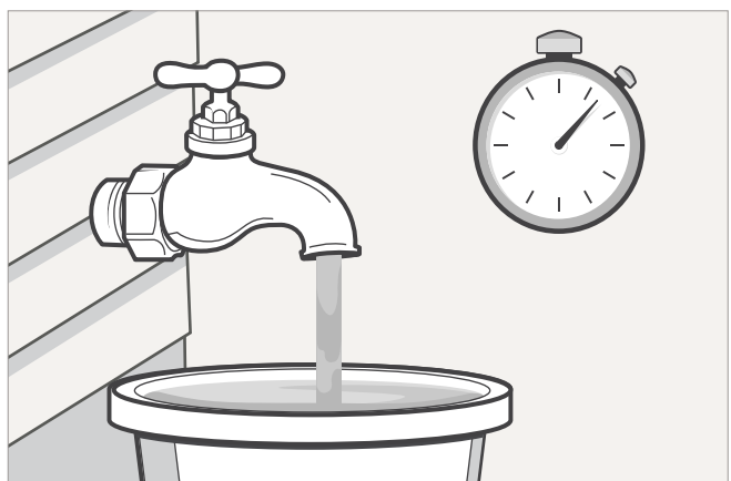
Abbildung 2: Stellen Sie einen Eimer unter den Wasserhahn und entfernen Sie alle Durchflussbegrenzer oder Perlatoren, die den Wasserfluss behindern könnten. Halten Sie eine Stoppuhr in der Hand, drehen Sie den Wasserhahn vollständig auf und starten Sie die Stoppuhr. Stoppen Sie die Uhr, wenn das Wasser den Rand des Eimers erreicht. Verwenden Sie die Gleichung für den Eimertest , um die maximale sichere Durchflussrate Ihres Systems zu berechnen.
