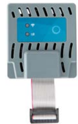
PC-WiFi WLAN-Modul für PRO-C Steuergeräte, Verwaltung in Centralus-Software Seite 118
